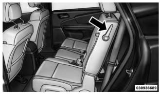
Tip 'n Slide<sup>TM</sup> Control Lever
